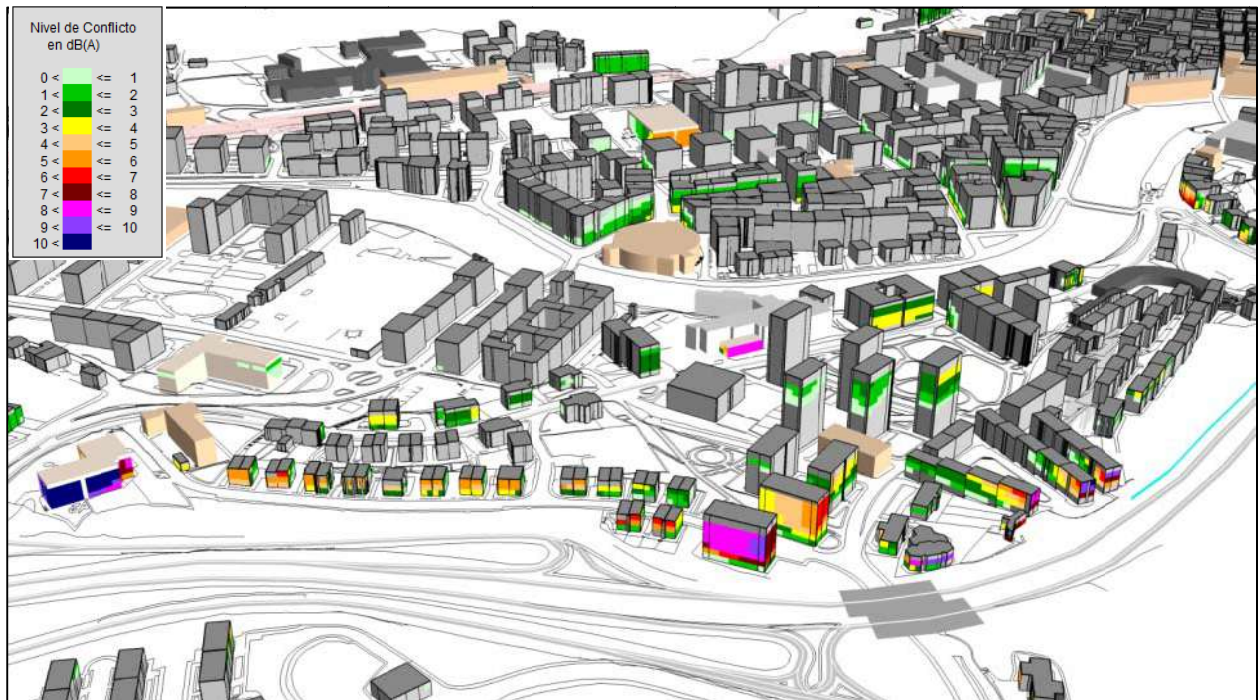
Detalle del mapa de conflicto en fachada. Ruido ambiental total. Período nocturno, L_n dB(A) Edificaciones próximas a la A-I
